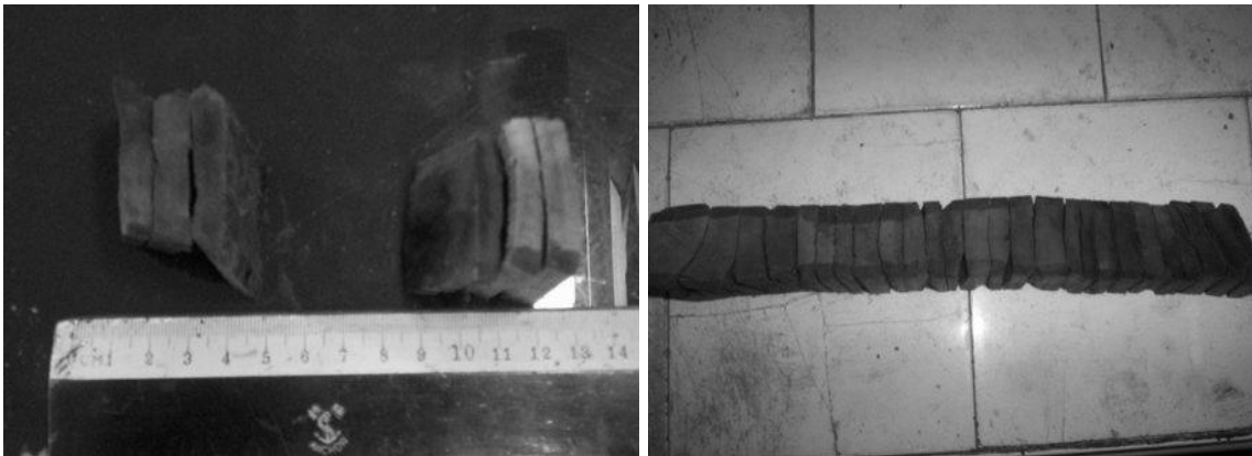
Figuras 3.8 y 3.9: Sauce: tabla central y probetas de densidad.
