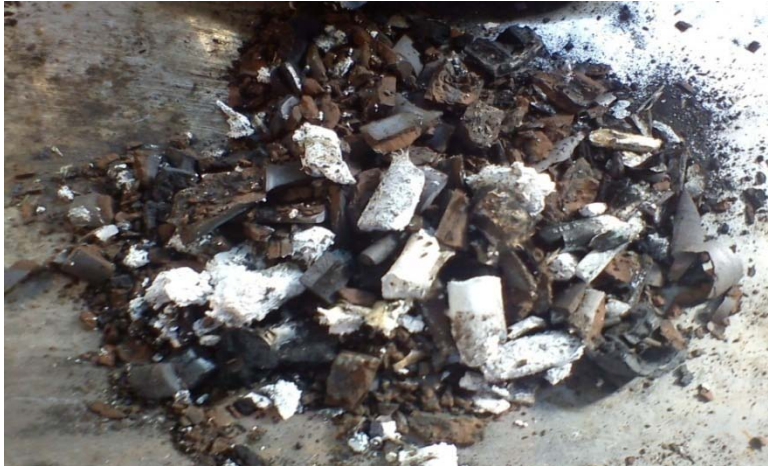
Figura 3.8. Barro mezcla de pilas alcalinas y de cinc-carbón. Se observa la pasta de cinc (blanco) el óxido de manganeso (marrón) y el carbón (negro).
