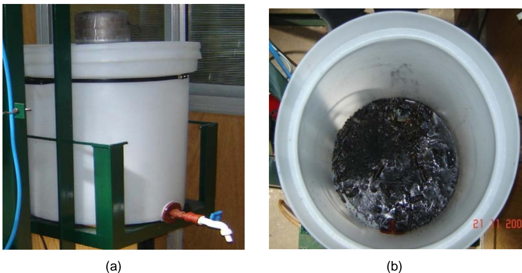
Figura 3.7. Reactor de lixiviación: (a) Vista completa; (b) interior del reactor con la mezcla de barro pilas y el ácido biogenerado.
