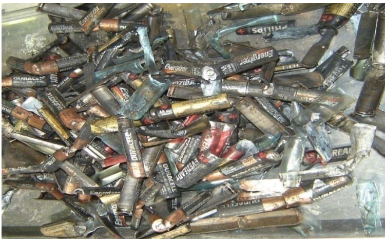
Figura 3.9. Carcasas de acero de las pilas. En la imagen se aprecian también algunas carcasas de cinc metálico y envolturas de plástico.
