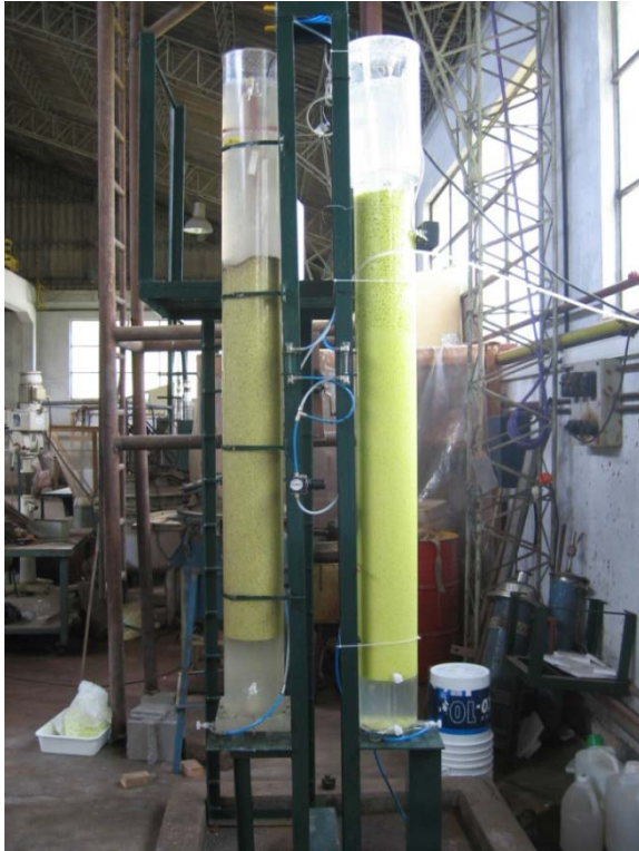
Figura 3.2. Planta de producción de medio ácido reductor biogenerado compuesta por dos biorreactores air-lift . Br1 (izquierda) y Br2 (derecha).
