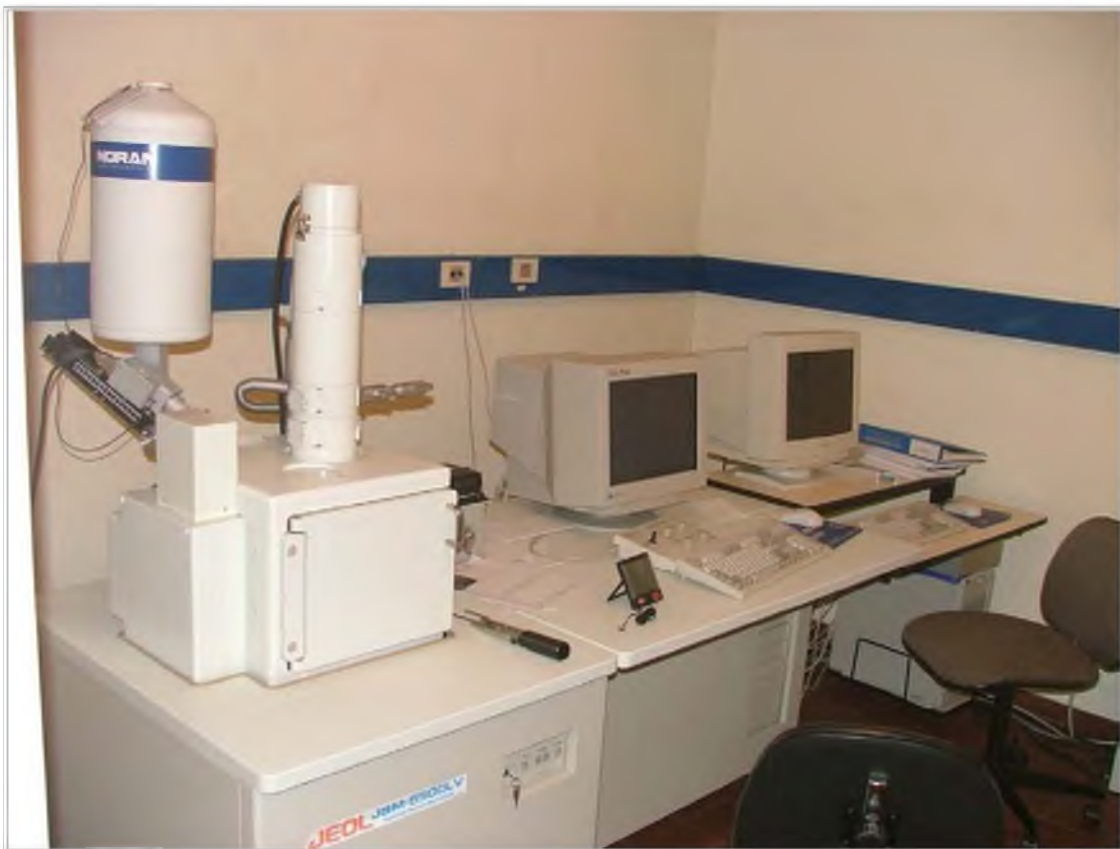
Figura 2.3: Equipo de Microscopio electrónico de barrido y EDAX. Laboratorio de microscopía electrónica, Facultad de Ciencias - UDELAR (Montevideo).
