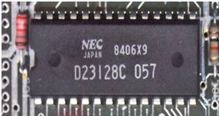
PROM D23128C en la placa base de una Sinclair ZX Spectrum
