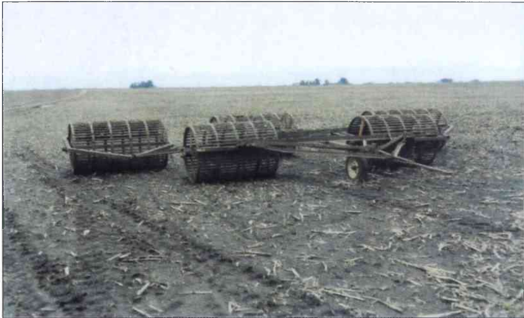
Foto 3- El rolo desterronador destruye los agregados del suelo, favoreciendo el posterior “planchado” y sellado de la superficie por efecto de las lluvias.
