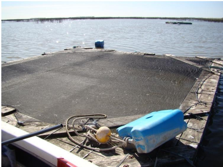
Figura A-1: Jaula flotante en funcionamiento en la laguna la Salada de Monasterio.
