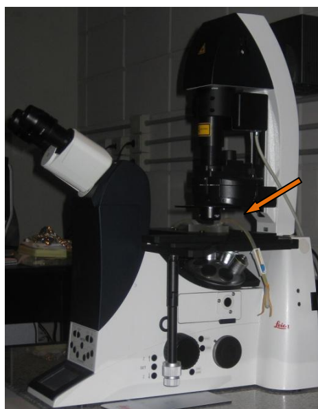
Figura 3. Microscopio de escaneo láser confocal invertido Leica TCS SP5, Leica Microsystems, Wetzlar, Germany. La flecha señala una celda con una sección de manguera.
