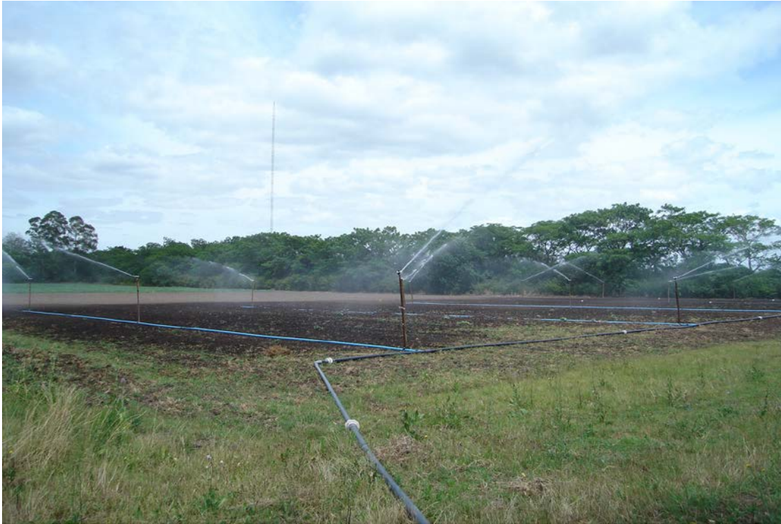
Figura. 1. Simulación de lluvia en las parcelas experimentales a través del sistema de riego por aspersion.
