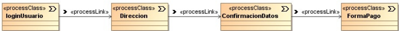
Figura 41: Diagrama de navegación del proceso de checkout en la página de la librería online UFV después del refactoring "Eliminar <navigationLinks> innecesarios"
