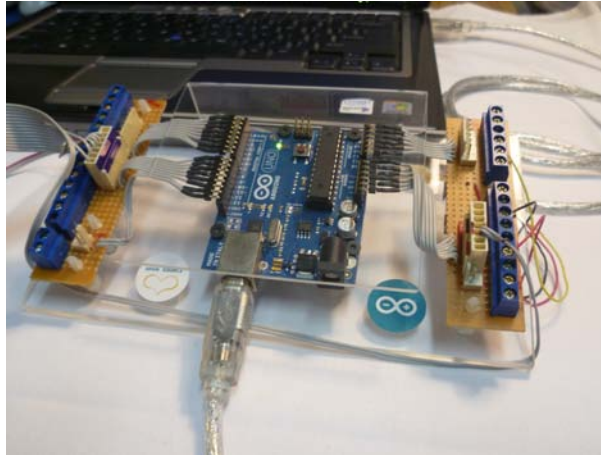
Figura 4. Placa y conexión a la PC
