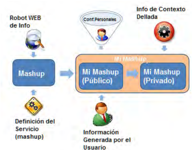
Fig. 12 – Esquema de detallado del proceso de personalización de mashups de PLASMA [74]
