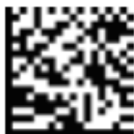
Figura 4. Esquematización símbolo GS1Datamatrix ECC-200
