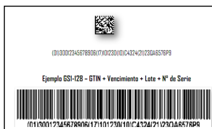
Figura 5. Esquematización GS1 Datamatrix ECC 200 – GTIN + Vencimiento + Lote + N° de Serie
