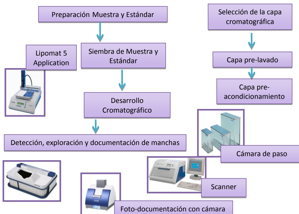
Figura 1. Procedimiento para el desarrollo de HPTLC
