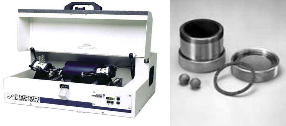
Figura 2.13. a). Molino SPEX 8000 b). Cilindro de molienda, tapa, bolas y sello metálico.
