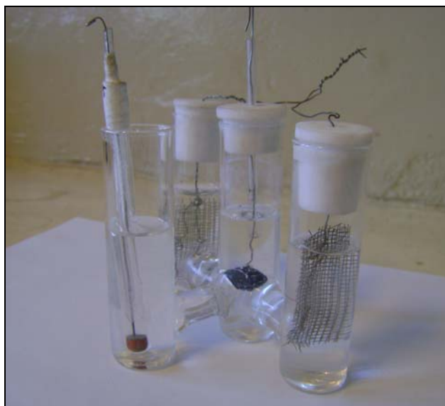
Figura 2.8. a). Esquema de la celda. b) Foto de una de las celdas electroquímicas utilizadas en este trabajo.
