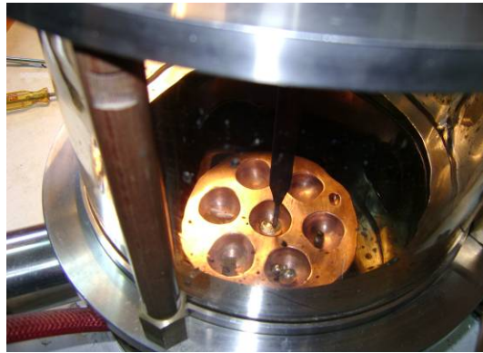
Figura 2.2. Fotografía del crisol con los metales a fundir.
