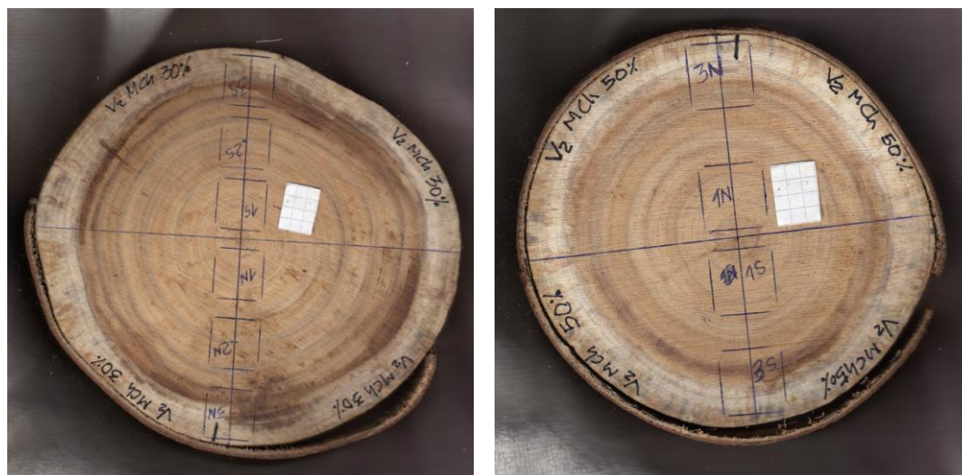
Figura 3-5. Densidad normal. Rodajas marcadas para la elaboración de probetas (2cm x 2cm x 2cm). (izq.): árbol MCh V2 , 30% de la altura total, posiciones en el radio a, b y c, en radios norte y sur; (der.): árbol MCh V2 , 50% de la altura total, posiciones en el radio a y b, en radios norte y sur
