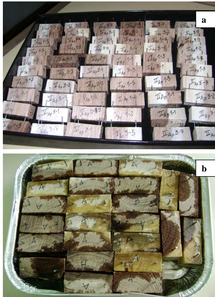
Figura 3-8. Cambios dimensionales. (a): Probetas radiales acondicionadas para su ingreso a estufa; (b) probetas tangenciales en proceso de hidratación para su saturación.
