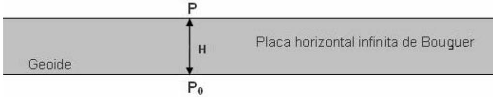
**Figura 2.2** – Placa horizontal infinita de Bouguer (modificado de Hofmann y Moritz, 2005)
