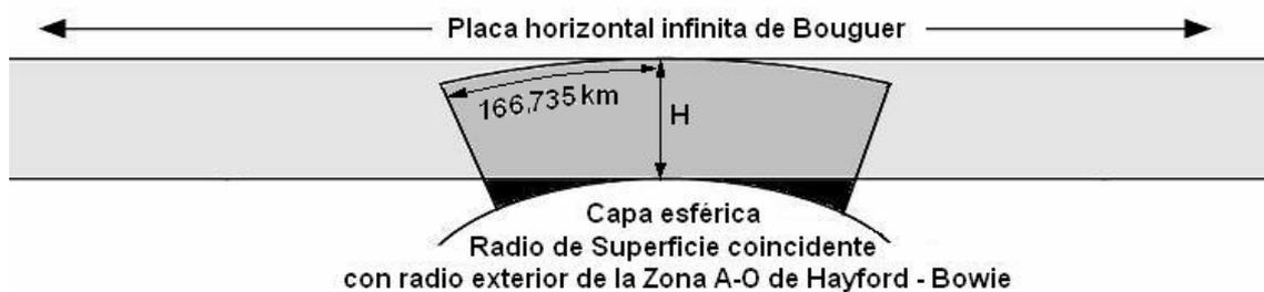
**Figura 2.3** – Geometría de la capa esférica en relación con la lámina horizontal infinita de Bouguer (modificado de LaFehr, 1991)
