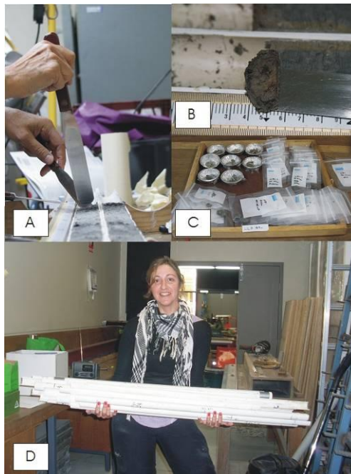
Figura 5. A: Extracción de muestra; B: Porción de la muestra extraída con la espátula; C: Muestras separadas y guardadas; D: Finalización de apertura del testigo LL3 (10 tubos de PVC cortados y vacíos).
