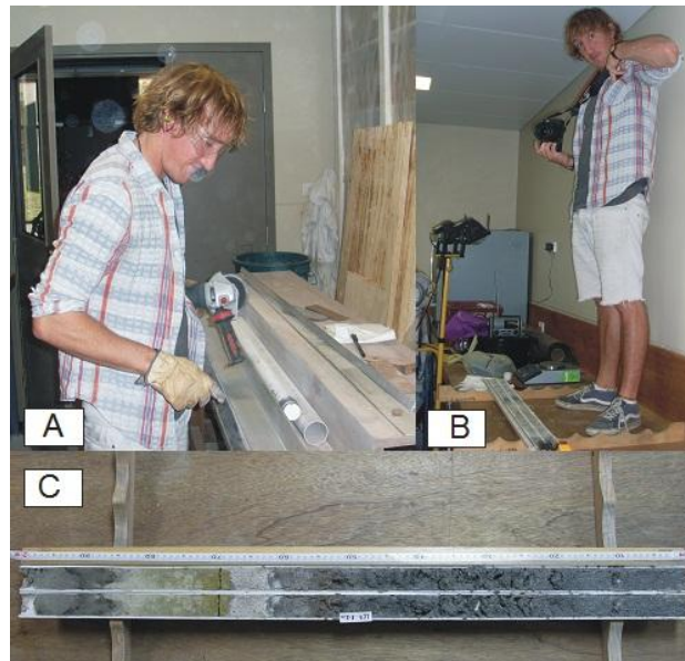
Figura 4. A: Apertura sagital con la sierra circular; B: Toma de fotografías; C: Ejemplo de un metro de testigo fotografiado.
