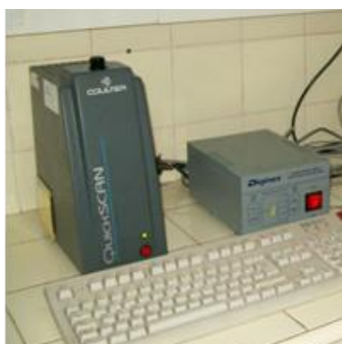
Figura 4.2. Analizador óptico vertical de barrido QuickScan (Beckman Coulter, USA)
