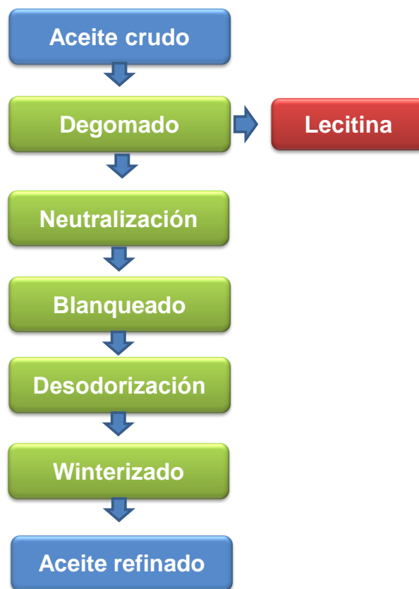
Figura 1.8. Diagrama de flujo de un proceso de refinación de aceites vegetales
