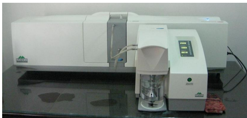
Figura 4.3. Analizador de tamaño de partículas Malvern Mastersizer (Malvern Instruments Ltd., UK)
