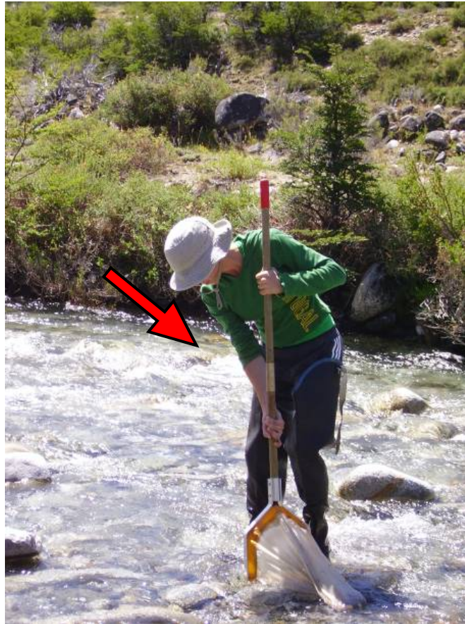
Fig. 22: toma de muestras de macroinvertebrados según la metodología de muestreo empleando el sistema de pateo (“Kick”).
