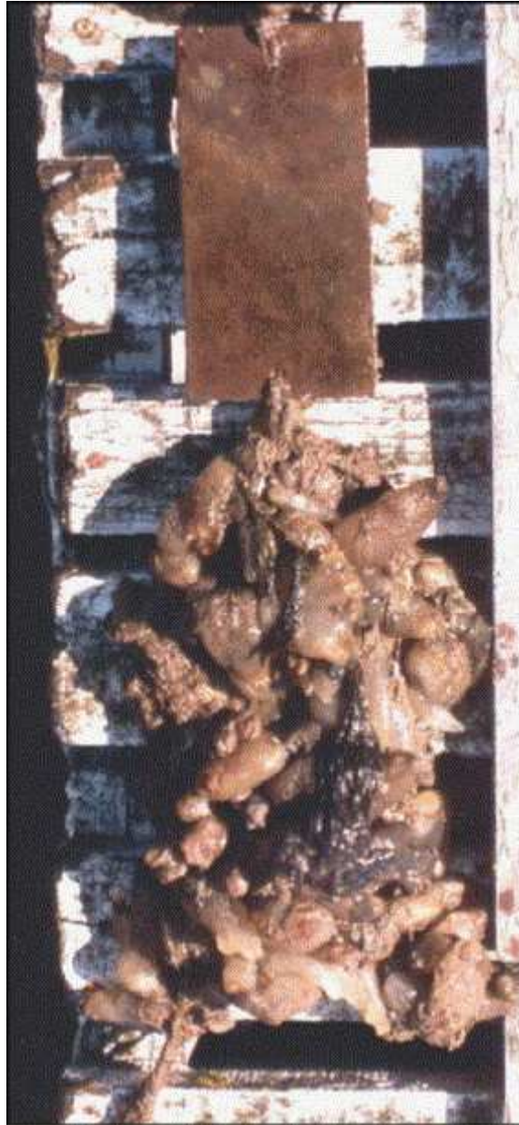
Figura 34. Paneles expuestos en el Puerto de Mar del Plata durante 12 meses; panel superior: pintura de tanato cúprico; panel inferior: control de acrílico.
