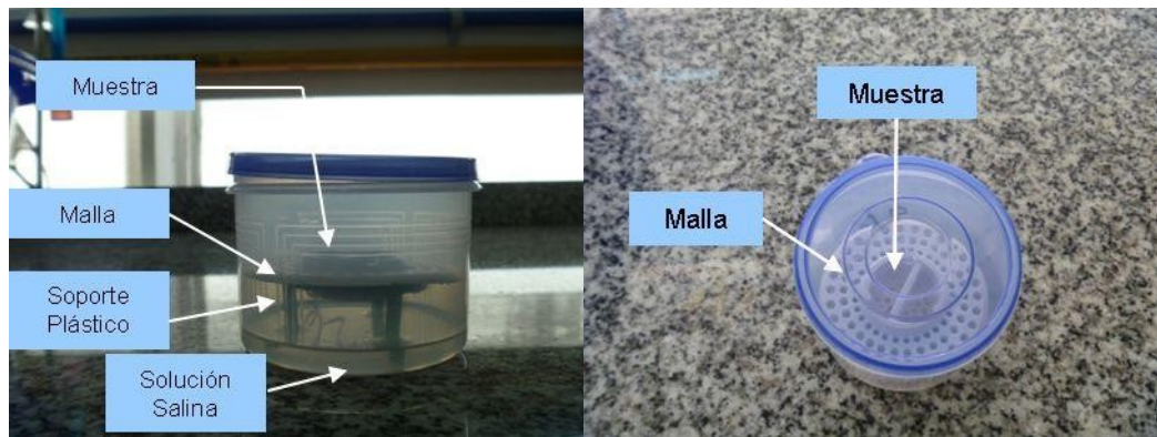
Fig. 3.5- Sistema utilizado para lograr el equilibrio entre humedad de las muestras y de la atmósfera circundante.
