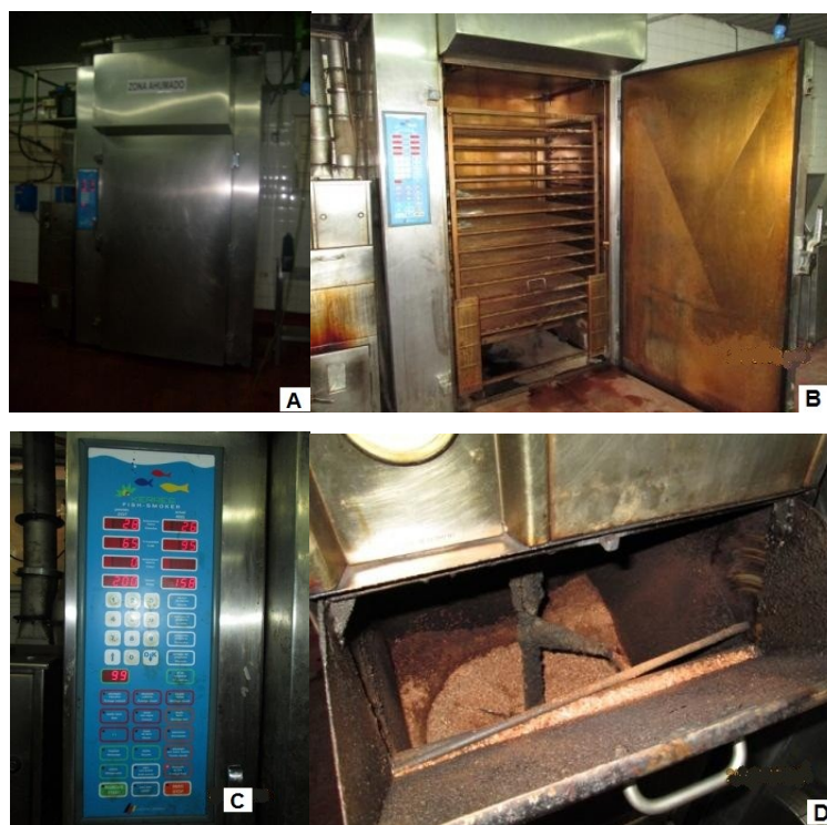
Fig. 3.6- A- Horno de ahumado cerrado. B- Horno abierto. C- Pantalla Control Digital. D- Generador de humo, sistema de provisión de aserrín.
