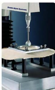
Figura 3.7. Sensor TA 108 utilizado para ensayo de extensibilidad
