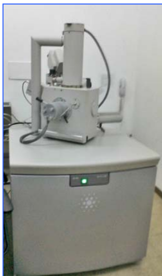
Figura 4.6. Microscopio ambiental electrónico de barrido (FEI Quanta, Oregon EEUU)
