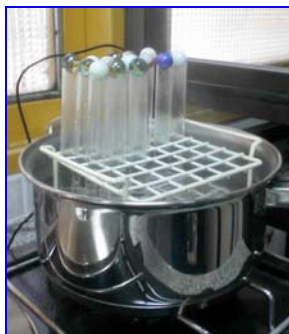
Figura 4.5 .Arreglo experimental para determinar la cantidad de agua absorbida en función del tiempo de cocción.
