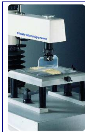
Figura 4.3 Sensor A/LKB, utilizada para los ensayos de corte sobre fideos cocidos.
