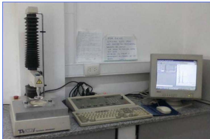
Figura 3.6. Texturómetro TA-XT2i (Stable Micro System, Surrey, UK)
