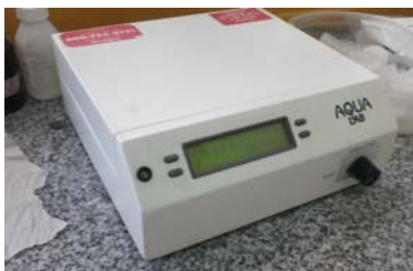
Figura 5.3. Medidor de actividad de agua AquaLab Series 3 (Pullman, Estados Unidos)
