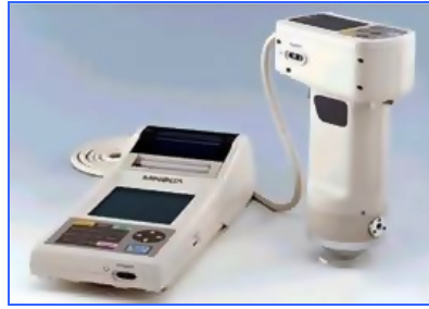
Figura 4.2. Colorímetro Minolta CR400
