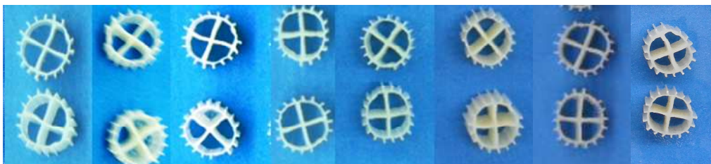
Figura 6.14. Desarrollo de biomasa adherida sobre soportes Kaldnes K1 en barros activados alimentados con fenol. De izquierda a derecha: soportes sin contacto con barros activados; 31, 50, 54, 76, 84, 98 y 129 días de operación.
