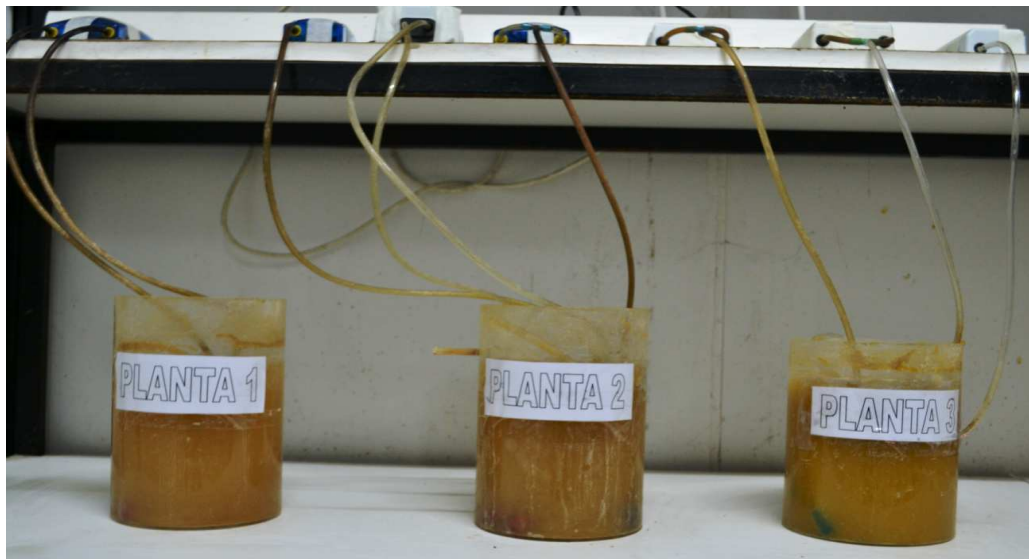
Figura 2.1. Fotografía de los reactores de barros activados utilizados en este trabajo de Tesis.
