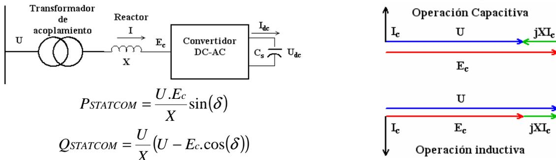
Fig. 4–Diagrama esquemático del STATCOM y diagramas fasoriales de operación.
