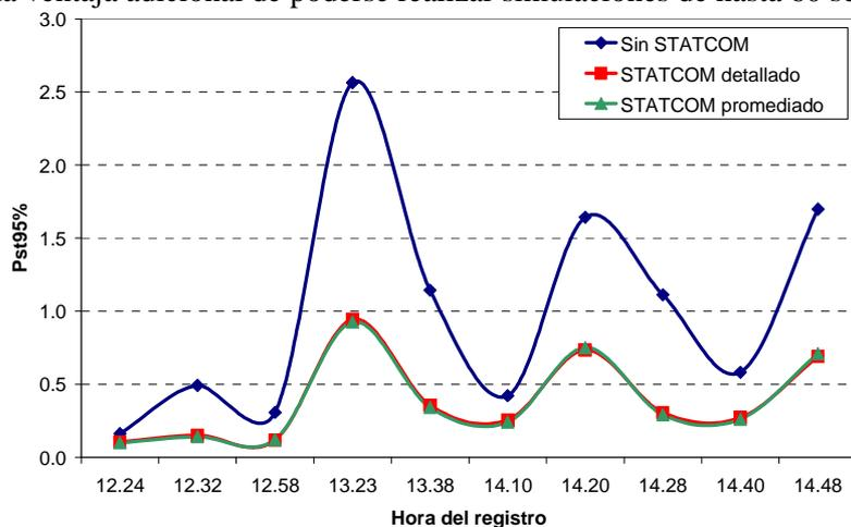
Fig. 22–Medición de Flicker sin y con STATCOM.
