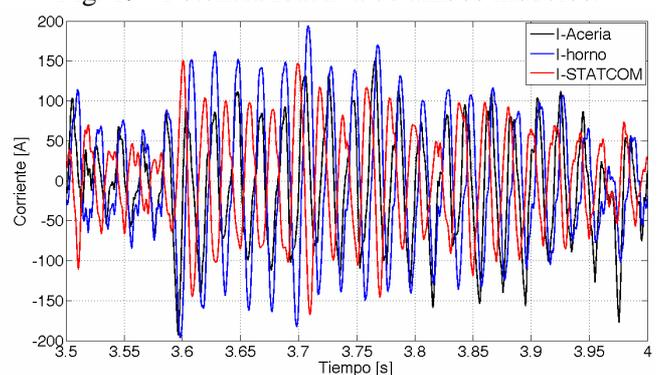
Fig. 21– Corriente en Acería, horno y STATCOM.
