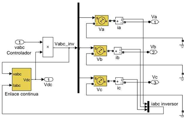
Fig. 10- Modelo SIMULINK del inversor.
