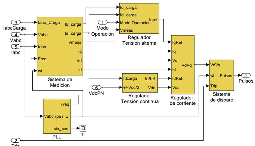
Fig. 8– Modelo del sistema de control del STATCOM.
