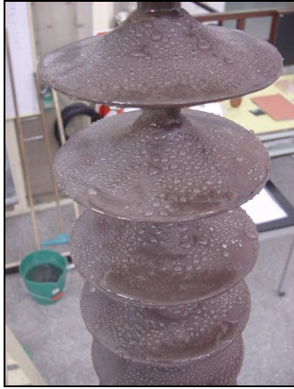
Foto 9. Hierro, sílice, cal. Distribución concentrada en el extremo de una mitad de las aletas
