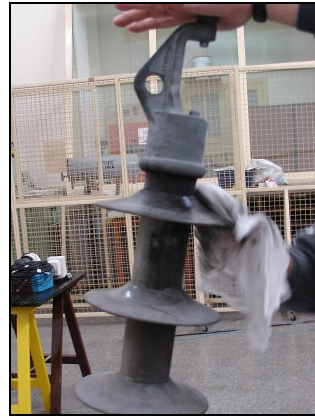
Foto 3. Retiro de material contaminante de la superficie
