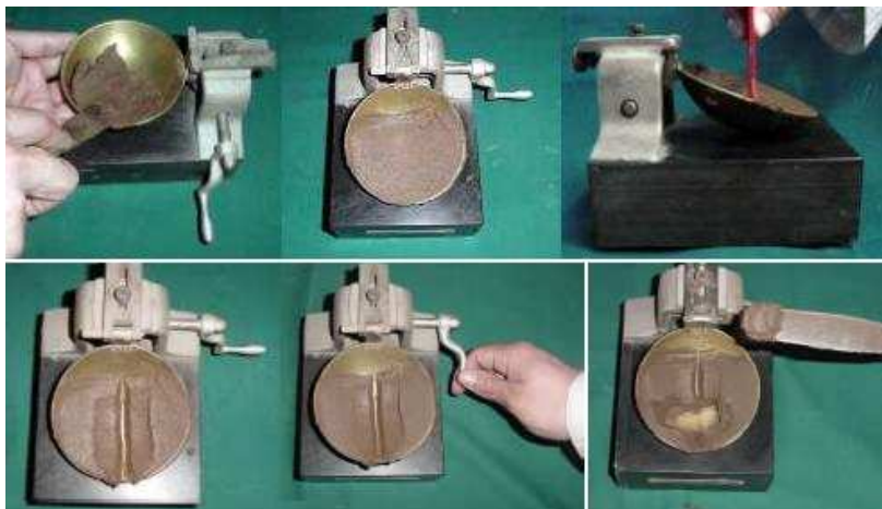
Figura 3.3. Etapas para la determinación del límite líquido mediante el aparato de Casagrande.
