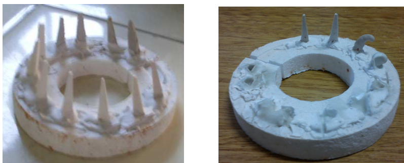
Figura 4.3. Placas del ensayo de Cono Pirométrico Equivalente (CPE), antes y después del ensayo,
