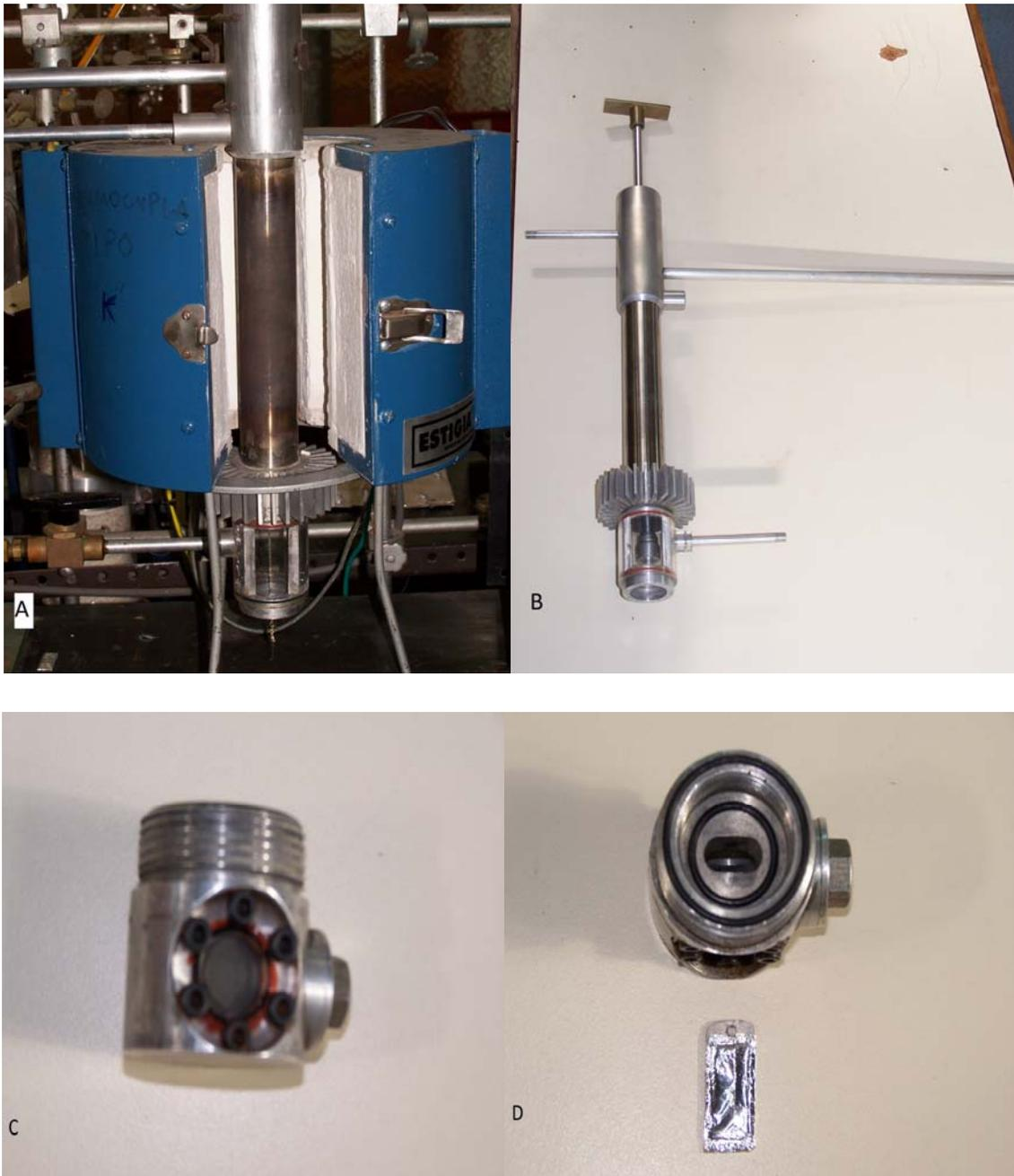
Figura 4: A- Reactor montado dentro del horno, B- Reactor completo fuera del horno, C- Celda con ventana de acrílico, D- Porta muestra que se inserta dentro de la celda para su transporte en atmósfera controlada.
