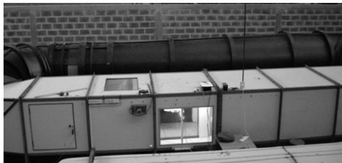
Figura 1. Túnel aerodinámico del LaCLyFA.
