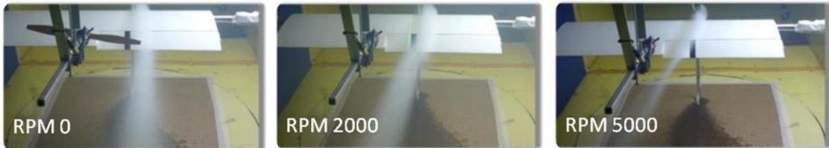
Figura 5. Vista desde arriba del ala con humo para diferentes RPM.
