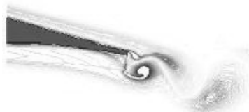
Figura 2. Esquema de las estructuras vorticosas contrarrotativas.
