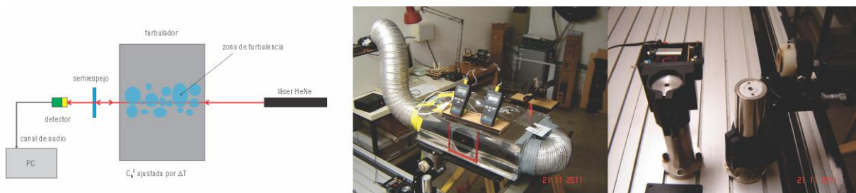
Figura 1. Izquierda: esquema del arreglo experimental. Centro: turbulador. Derecha: detector de intensidad lumínica.
