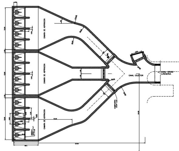
Figura 1.- Planta de la Estación de Bombeo Ensayada
