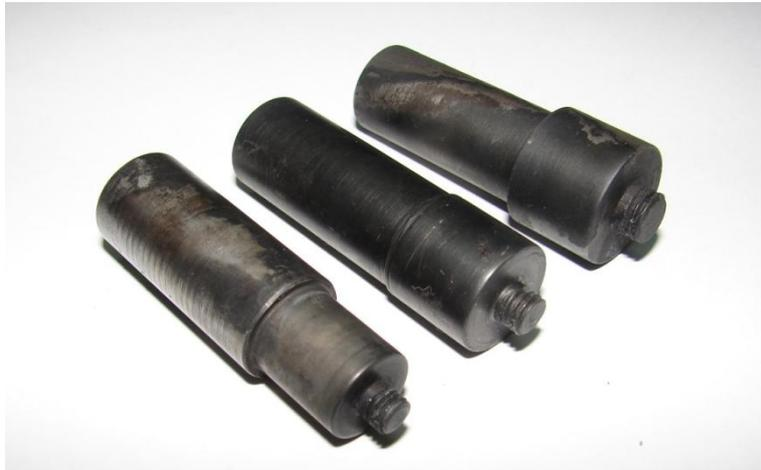
*Figura 3: Fotografía de las herramientas de soldadura luego del tratamiento térmico de temple y revenido.*
