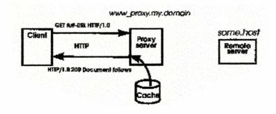
El programa cliente del usuario habla con el proxy server en lugar de con el servidor real. El proxy server evalúa el requerimiento y decide si pasa o no. Si el requerimiento es aprobado, el proxy server habla con el servidor real, y procede a retransmitir el requerimiento del cliente al servidor y a enviar la respuesta al cliente.
