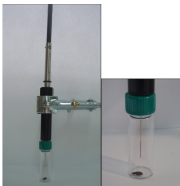
Fig.III.5.b.2. Toma de muestra de VOC de U. dermestoides mediante técnica HS-SPME.
