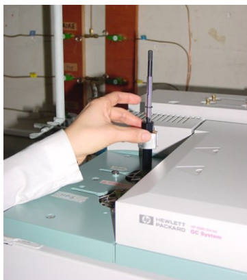
Fig.III.5.b.1. Inyección de la muestra de los VOC de T.castaneum en el CGC.
