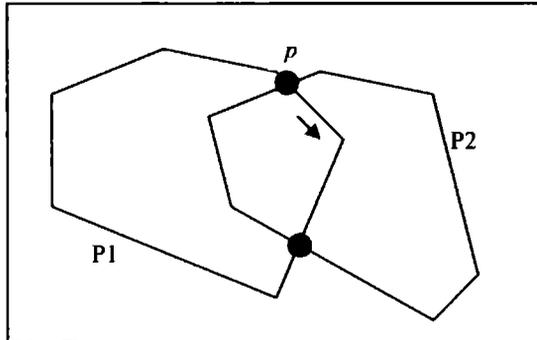
**Figura 4.3.-** Intersección mediante algoritmo Switching Trip.
