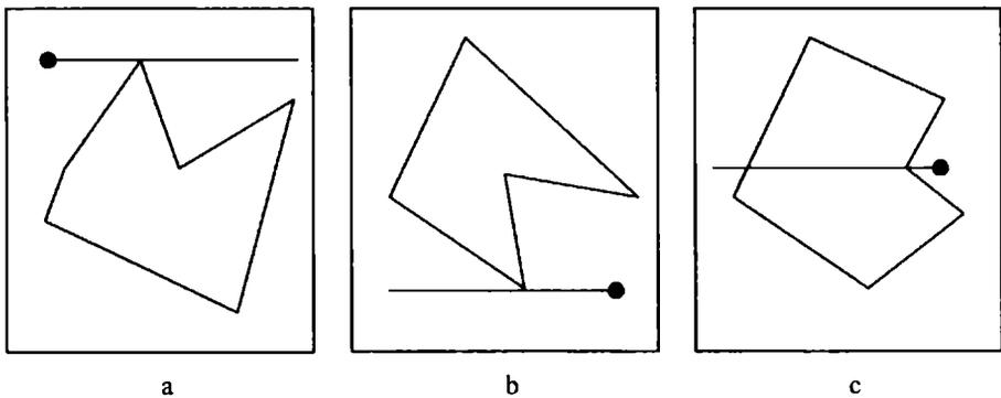
**Figura 4.10.-** Casos particulares de intersección de la semirrecta con vértices
