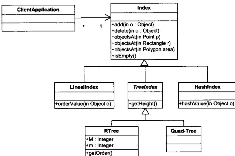
**Figura 6.9.-** Generalización a varias estructuras de índices.
