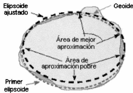
**Figura 5.5.-** Uso de diferentes datums, según la aproximación que se necesite.
