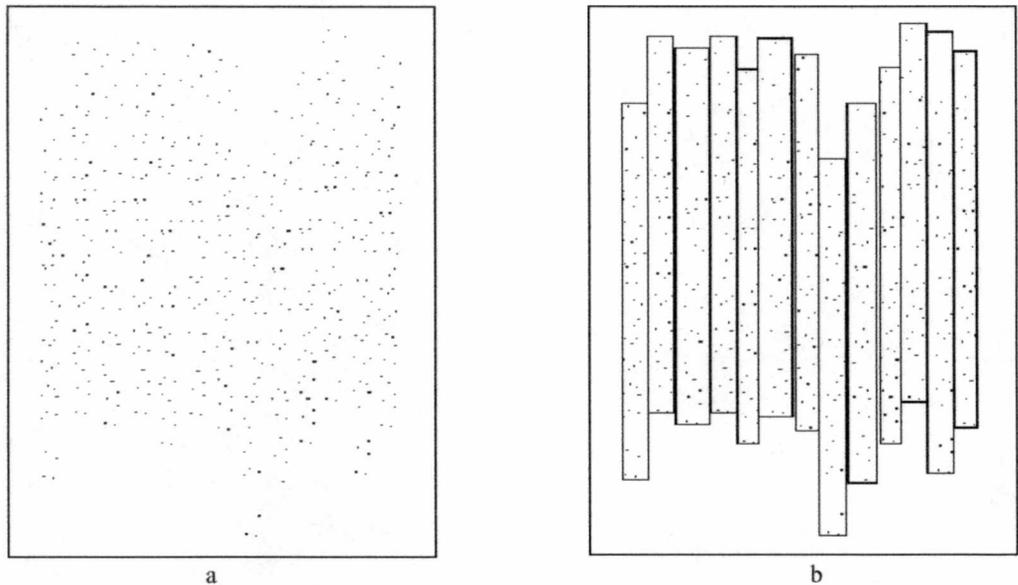
**Figura 3.12.-** (a) Conjunto de puntos aleatoriamente distribuidos en el espacio y (b) último nivel del *R-Tree empaquetado* generado por la carga masiva mediante el orden de nodos obtenido considerando solamente la coordenada x de cada uno.
