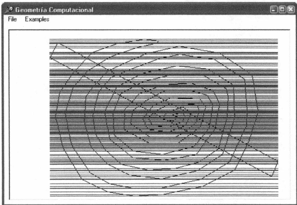
**Figura 7.27.-** Líneas de Slabs Generadas.
