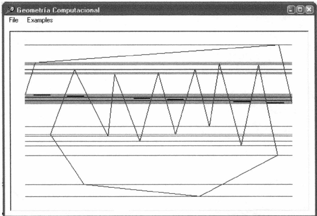
**Figura 7.17.-** Líneas de Slabs Generadas.
