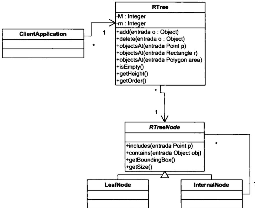
Figura 6.4.- Modelo básico del R-Tree.
