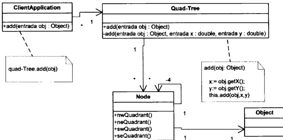
**Figura 6.2.- Modelo Final del Quad-Tree**
