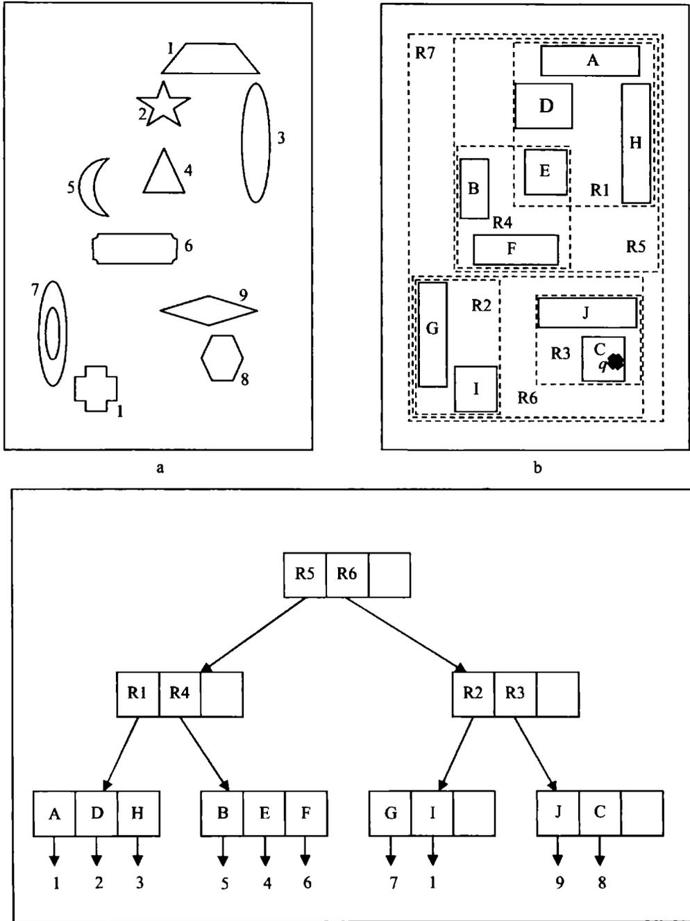
**Figura 3.10.-** (a) Conjunto de objetos distribuidos espacialmente, (b) extensiones espaciales de los bounding-boxes de los objetos y de los nodos del R-Tree que los indexa, más un punto de consulta  $q$ ; y (c) representación de los nodos y referencias del R-Tree.
