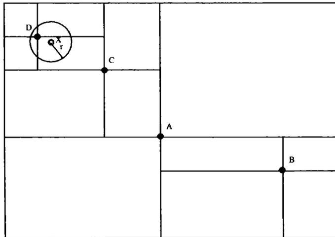
**Figura 3.7.-** Búsqueda por proximidad en un Point quadtree
