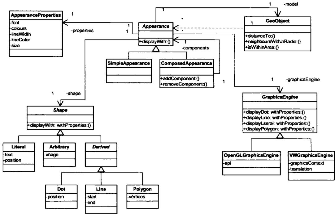
Figura 1.- Modelo, orientado a objetos, del patrón Appearance
