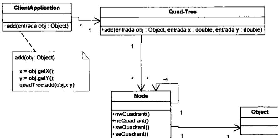
Figura 6.1.- Modelo Inicial del Quad-Tree.
