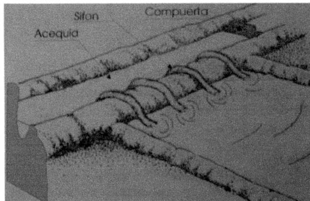
Figura 9.2.- Ejemplo de un equipo de riego gravitacional.
