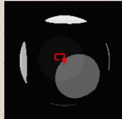
Búsqueda de i_{c+1}^c en i_c en base a centro de masa de i_c
