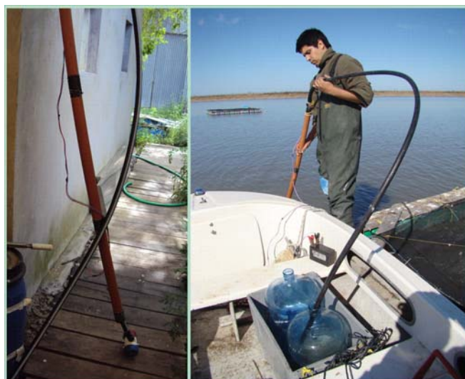
Figura III.6: Dispositivo especialmente diseñado para la toma de muestras de zooplancton y de su modo de uso.
