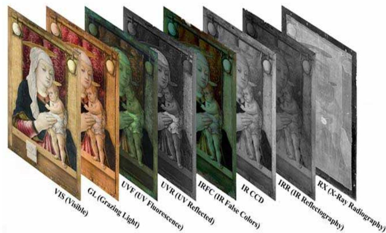
Fig.7.14: Bandas generadas mediante diferentes fuentes de la misma obra.
