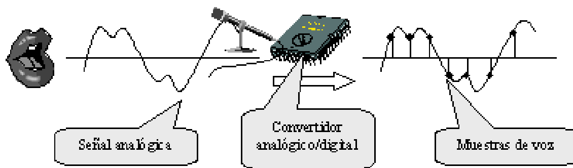
Figura 5.3 – Obtención de muestras de la señal de la voz.
