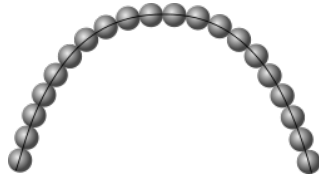
Figura 3.: Representación esquemática de un arco. Por definición, las partículas que componen un arco se encuentran mutuamente sustentadas, por lo que el arco colapsa al remover cualquiera de ellas.
