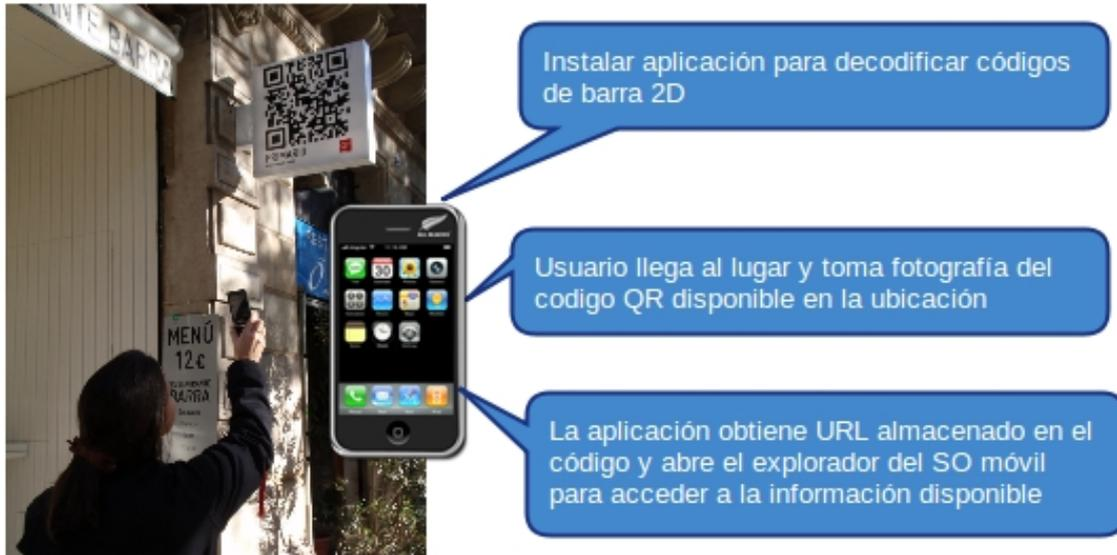
Figura 4.2.2 Funcionamiento de sensado por códigos de barra quick response
