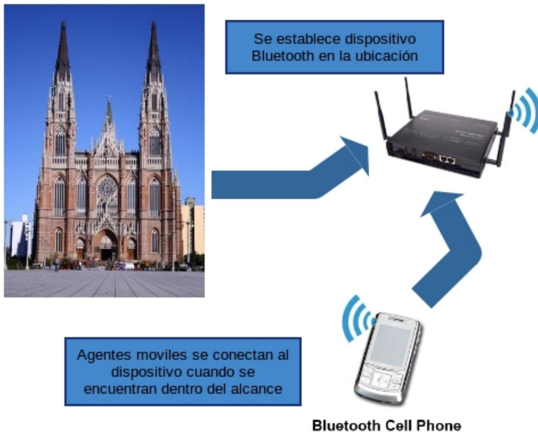
Figura 4.2.1 Esquema de funcionamiento para sensado por Bluetooth
