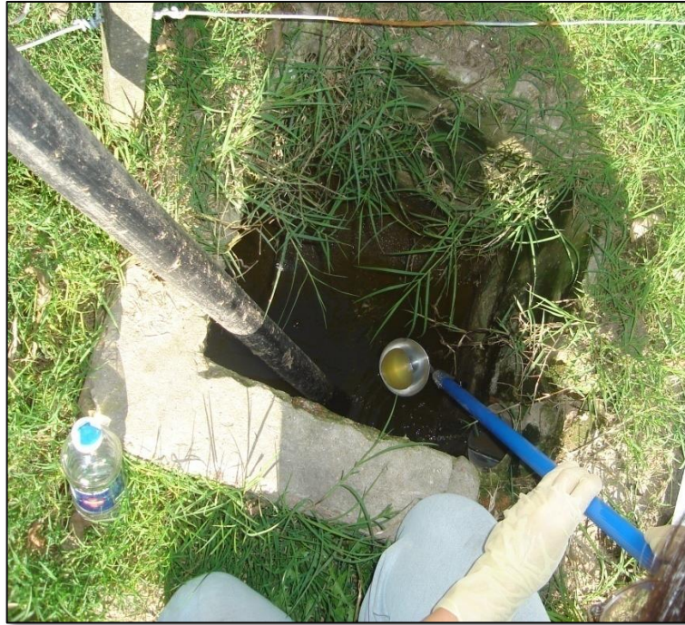
Figura II.3. Toma de muestra de pozo séptico.
