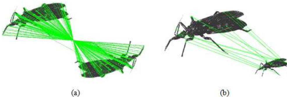
Figura 4.7: (a) Correspondencias entre una imagen y la misma rotada. (b) Correspondencias entre una imagen y la misma con escala menor.
