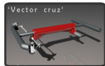
Se le asignó el término 'vector' por tratarse de una pieza que direcciona, da sentido y aporta una magnitud de desplazamiento. El término 'cruz' se debe a la configuración cruzada ortogonalmente de sus ejes de rotación
