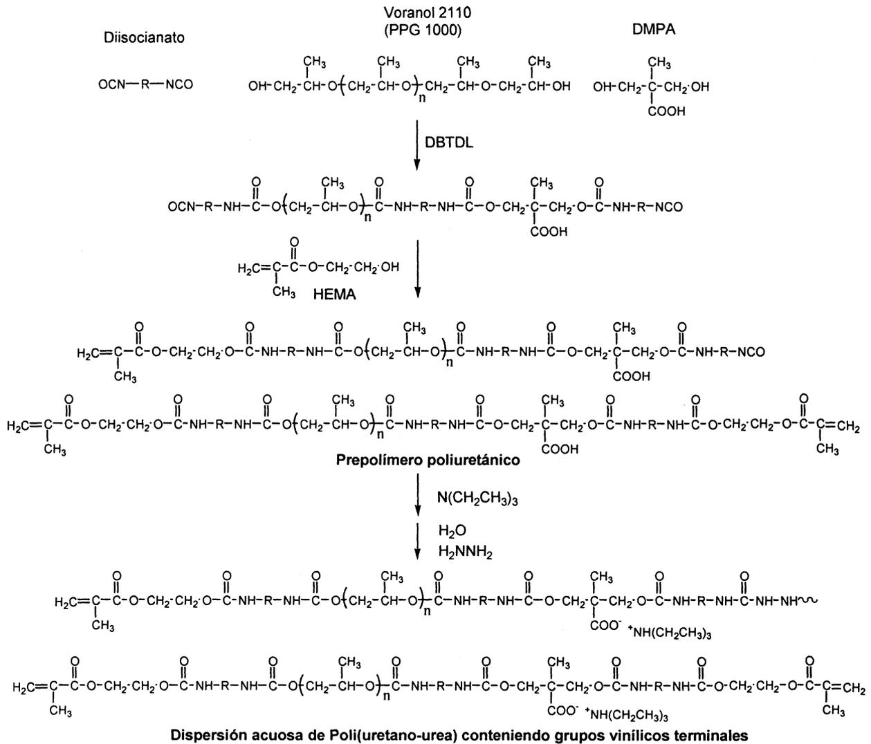
**Esquema II.2.1.2.1-** Síntesis esquemática de la dispersión acuosa de poliuretano.
