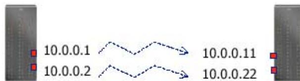
La aplicación en el extremo emisor separa los datos entre las interfaces de salida y transmite hacia dos diferentes IP's. Por su parte la aplicación en el extremo receptor recibe los datos desde las dos interfaces y luego los ensambla. Pero los potenciales riesgos son que cada uno de los flujos competirá contra el otro por ancho de banda y además se incrementaría el porcentaje de paquetes fuera de orden.
