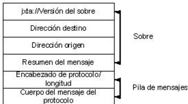
Figura 8.2 – Estructura de los mensajes JXTA
