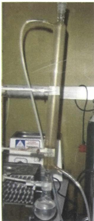
Figura II.3.3: reactor térmico para muestras de agua contaminada con nafta.
