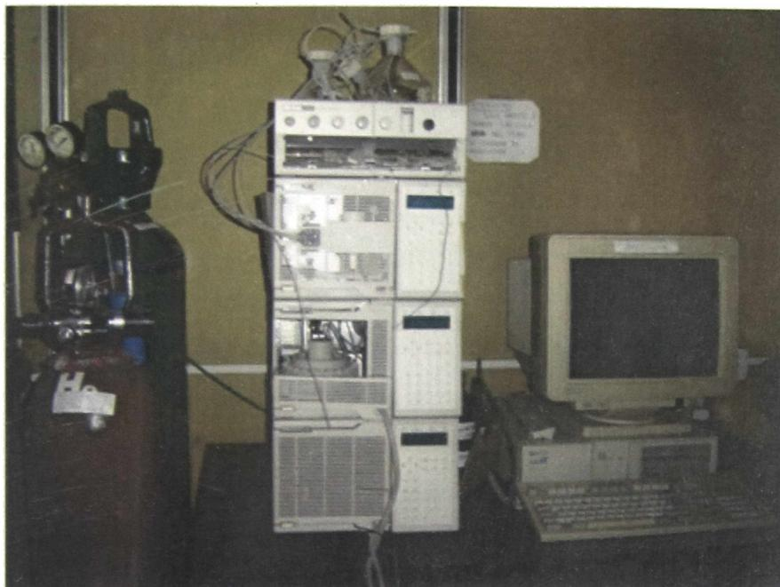
Figura II.1.1: HPLC con detección UV.
