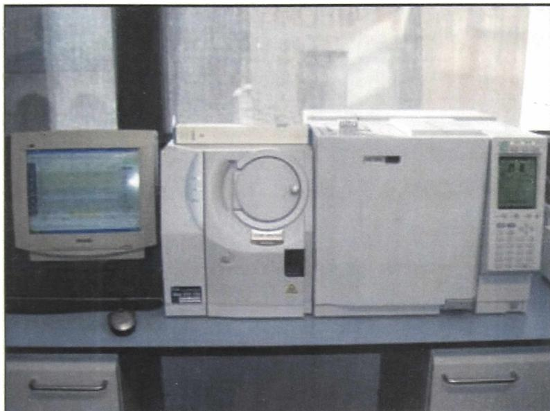
Figura II.1.2: Cromatógrafo de gases con detector de masas.
