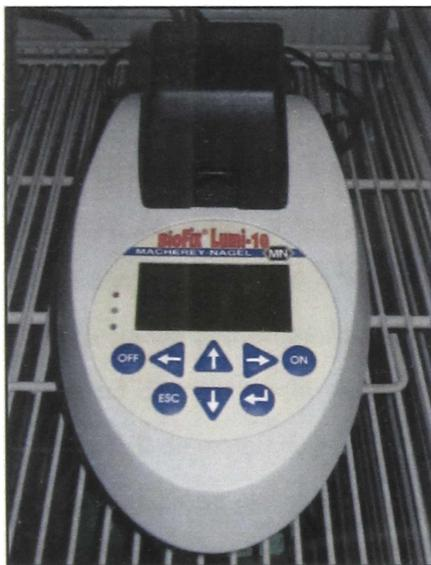
**Figura II.1.9:** Luminómetro
