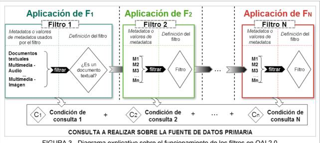
FIGURA 3 - Diagrama explicativo sobre el funcionamiento de los filtros en OAI 2.0
