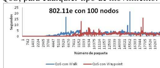
Figura 6: Comparación de QoS según la movilidad para 100 nodos
